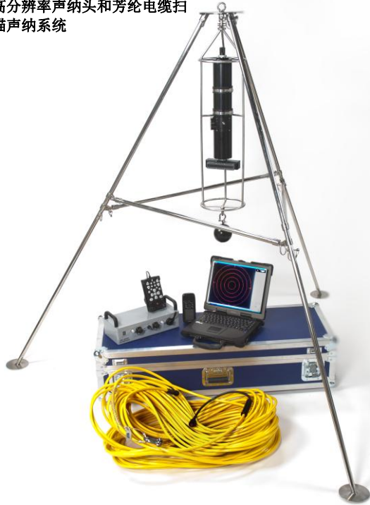
在防护罩中水平安装的 高分辨率扫描声纳
